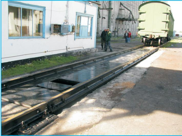
Весы вагонные тензометрические статического действия «Мастер Вес»<sup>ЖД</sup> предназначены для статического взвешивания железнодорожных вагонов при их остановке на платформе весов с регистрацией результатов взвешивания на табло прибора весоизмерительного.
