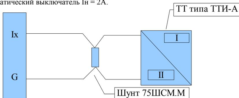
Шунт рекомендуется устанавливать максимально близко к прибору, и подключать экранированным проводом. Шунт к ТТ рекомендуется подключать проводом сечением не менее  $1.5\text{mm}^2$ . Для подключения токовых и измерительных цепей обязательно использовать разные клемные винты!
