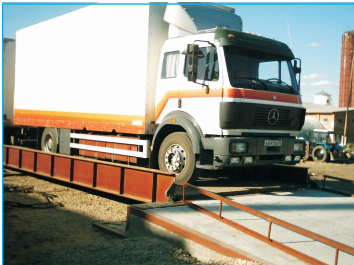
Автомобильные весы «Мастер Вес» предназначены для статического взвешивания автотранспорта с регистрацией результатов взвешивания на индикаторе весового терминала.
